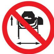
Nepohybujte míchačkou během provozu, může se převrátit nebo může dojít k poškození!
