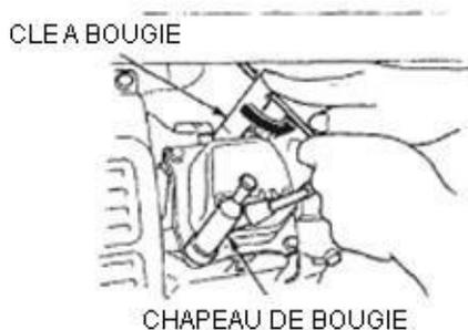
4) Vizualně zkontrolujte zapalovací svíčku. Pokud je izolátor prasklý nebo našťípnutý, odstraňte jej. Pokud chcete zapalovací svíčku znovu použít, očistěte ji drátěným kartáčem.
