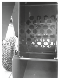
vyústění drtiče a výstupní síto s otvory 25 mm
