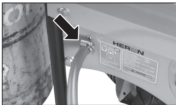
Způsob připojení plynové hadice k elektrocentrále Obr. 14
